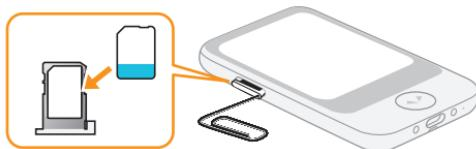
SIM カードスロットに nano SIM カードを装着し、本体に差し込みます。
